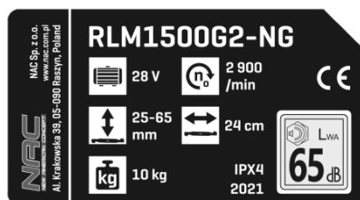
Табелка с технически данни, намираща се на корпуса на робота
