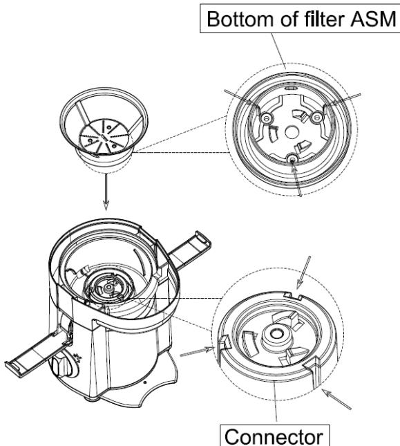
3. Instalați tava de reziduuri în poziția corectă pe flanșa corpului principal, așa cum se arată în diagramă.
