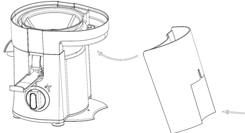
4. Τοποθετήστε το επάνω κάλυμμα στο επάνω μέρος του δίσκου χυμού όπως φαίνεται στο διάγραμμα. Κλειδώστε με τους πλαϊνούς σφιγκτήρες.
