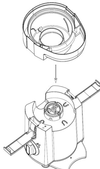
2. Instalați filtrul în conector în partea superioară a carcasei principale, aşa cum se arată în diagramă.
