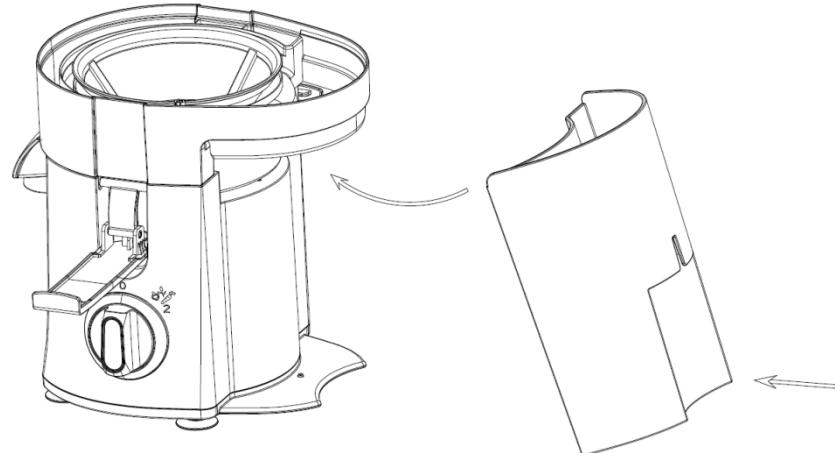
4. Instalați capacul superior peste partea superioară a tăvii de colectare a sucului, așa cum se arată în diagramă. Blocați cu clemele laterale.
