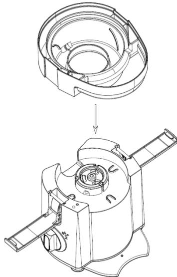
2. Τοποθετήστε το φίλτρο στον σύνδεσμο στο επάνω μέρος του κύριου περιβλήματος
