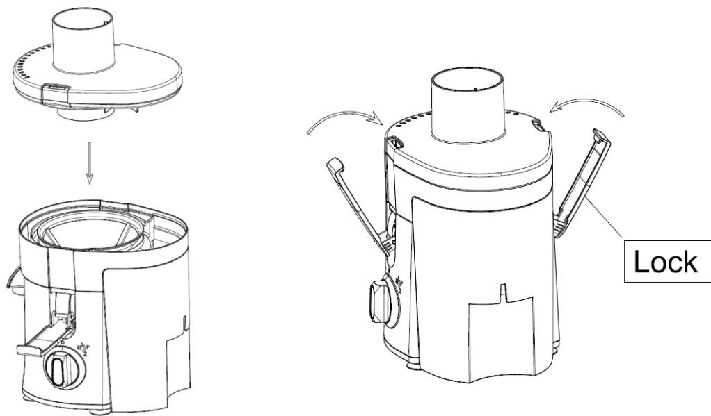
5. Instalați pistonul în pâlnia superioară a capacului superior, aşa cum se arată în diagramă.
