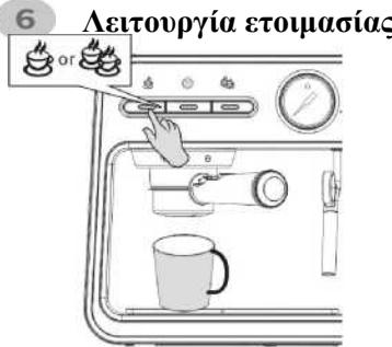
Τοποθετήστε πρώτα το φλιτζάνι όπως φαίνεται, επιλέξτε 1-φλιτζάνι ή 2-φλιτζάνι (βεβαιωθείτε ότι το φίλτρο καφέ είναι γυρισμένο μέσα στη μηχανή πριν πατήσετε το κουμπί).
