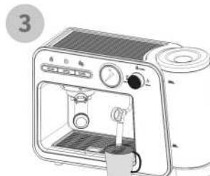
продължете да натискате бутона за включване/изключване, докато тръбата за пръска вода.
